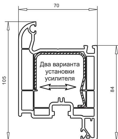
арт. № 103.273 пленка с двух сторон пленка с одной стороны усилитель арт. №113.270 алюм.усилитель арт. №115.003
