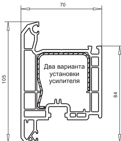
арт. № 103.203 наружное открывание пленка с двух сторон усилитель арт. №113.270 алюмин.усилитель арт.№115.003 (только для белых профилей)
