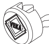
заглушка для водоотвода арт. № 143.051 цвет: белый, коричневый для отверстия \varnothing 10 мм
